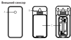
Внешний сенсор А - Индикатор (красный) В - Отверстие для крепления С - Отсек для батареек
