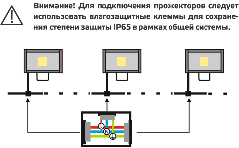
Рис. 1. Схема подключения прожектора к сети электропитания
