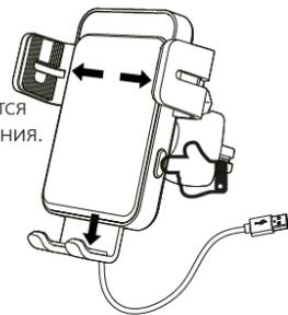
2. Поместите телефон. Устройство автоматически зажмет и автоматическое выравнивание по области зарядки
